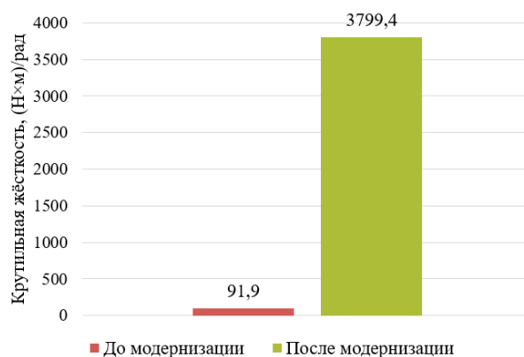
Рис. 1. Гистограмма значений крутильной жесткости привода главного движения
